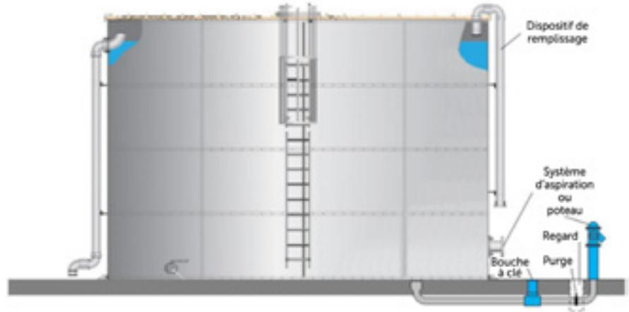
Les prises directes sur les citernes rigides sont admises si elles disposent d'un dispositif de capotage, souple ou rigide, qui garantit l'incongelabilité de la prise d'eau.
