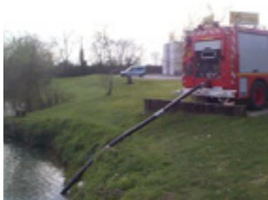
L'aspiration s'effectue par les équipements (aspiraux) des engins incendie stationnant sur une aire de mise en aspiration (voir [fiche technique 12](#)).
